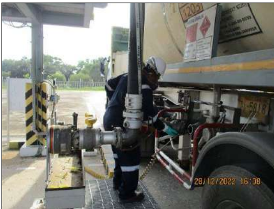
รูปที่ 2-43 การตรวจสอบสภาพถังบรรจุ NGL เพื่อเตรียมพร้อมก่อนการ Load ผลลัพธ์ NGL ลงถัง
