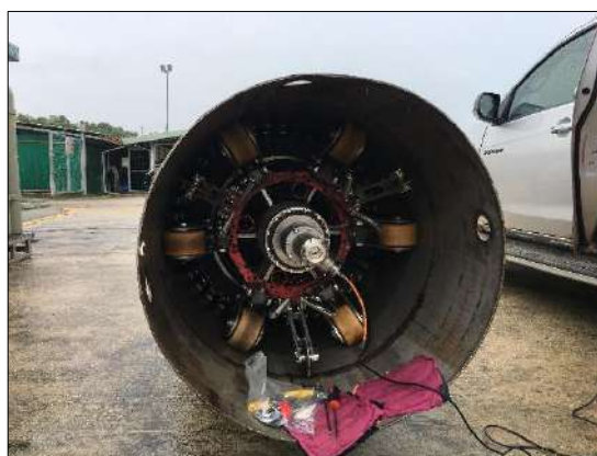
รูปที่ 2-68 การตรวจสอบความหนาของระบบท่อขนส่ง
