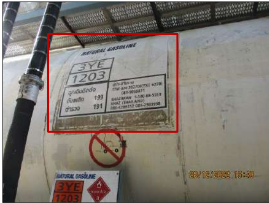
รูปที่ 2-37 การติดข้อสารเคมี สัญลักษณ์และความเป็นอันตรายที่รถขนส่งผลิตภัณฑ์
